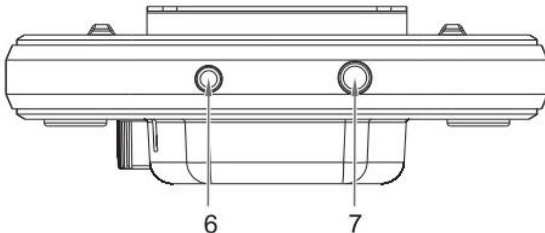
6. Вход для пьезоэлектрического звукоснимателя
