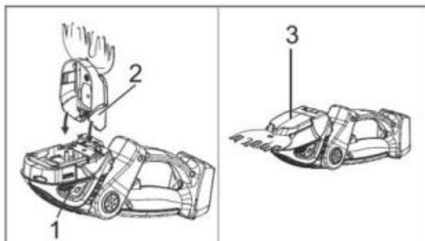
3. Зафиксируйте выступы (1) лезвия кустореза (3) или лезвия травореза (3) в направляющих (2).
