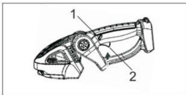
1. Сдвиньте ползунок блокировки (1) в сторону режущих лезвий большим пальцем и удерживайте его.
