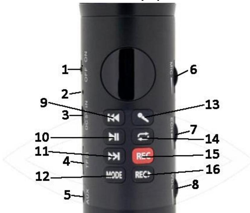
1. Кнопка Вкл/Выкл. Включает и отключает устройство.
