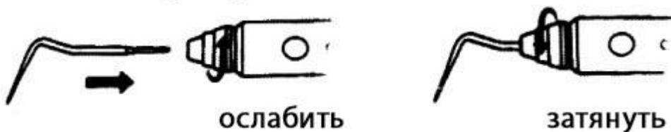
Предупреждение: Будьте осторожны, чтобы не получить ожог при установке наконечника ручки.
