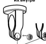
совместите гайки со слотом и поместите их внутрь
