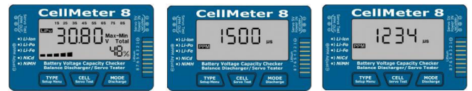
Тестовый режим средней точки сервопривода
