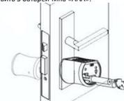
При аварийной ситуации снимите пластину, вставьте механический ключ и проверните на 30 градусов. Откройте дверь при помощи ручки.
