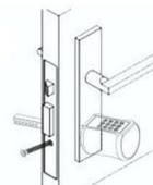
Установите ручку, затяните винты. Проверьте работу при помощи задней ручки.
