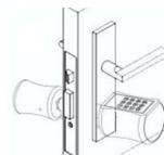
Снимите пластину, чтобы установить 3 батареи типа «AAA».
