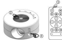
Расположите проектор с объективом вертикально к стене или экрану, включите проектор, отрегулируйте фокус (как на рис. 4) до тех пор, пока изображение не станет четким. Вставьте USB-накопитель в соответствующее место, как показано на рис. 5. Выберите соответствующий значок и войдите в подменю. Movie для видеофайлов, Photo для файлов изображений, Music для аудиофайлов, E-book для файлов TXT и нажмите ОК для отображения.
