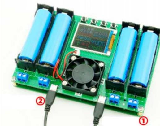
Нажмите «R/S», чтобы запустить программу. Программа запустится, указав «STA:CHG». Процесс зарядки записывает только время, емкость и энергию. После зарядки программа останавливает работу, указав состояние: «STA:END».
