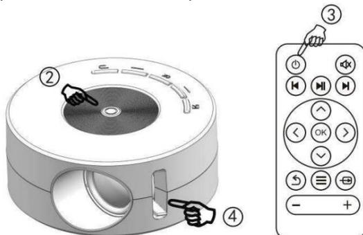
Расположите проектор горизонтально поверхности, объективом к стене или экрану. Включите проектор, отрегулируйте фокус (как на рис. 4) до тех пор, пока изображение не станет четким. Вставьте USB-накопитель в USB-разъем, как показано на рис. 5.
