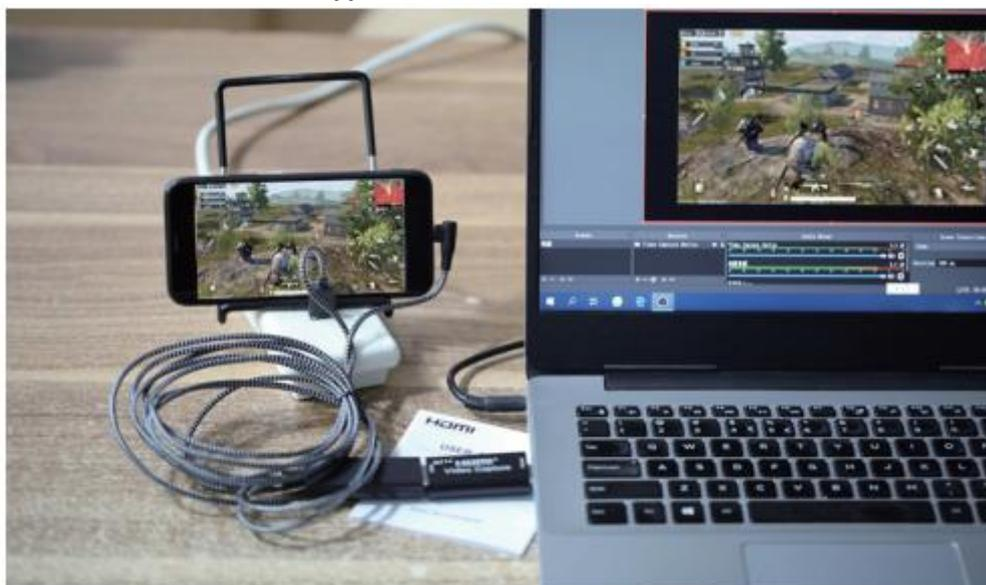
1. Подключите источник UHD-сигнала к HDMI-входу устройства видеозахвата с помощью HDMI-кабеля;
