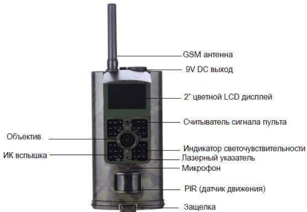
Рис1. Составные части камеры
